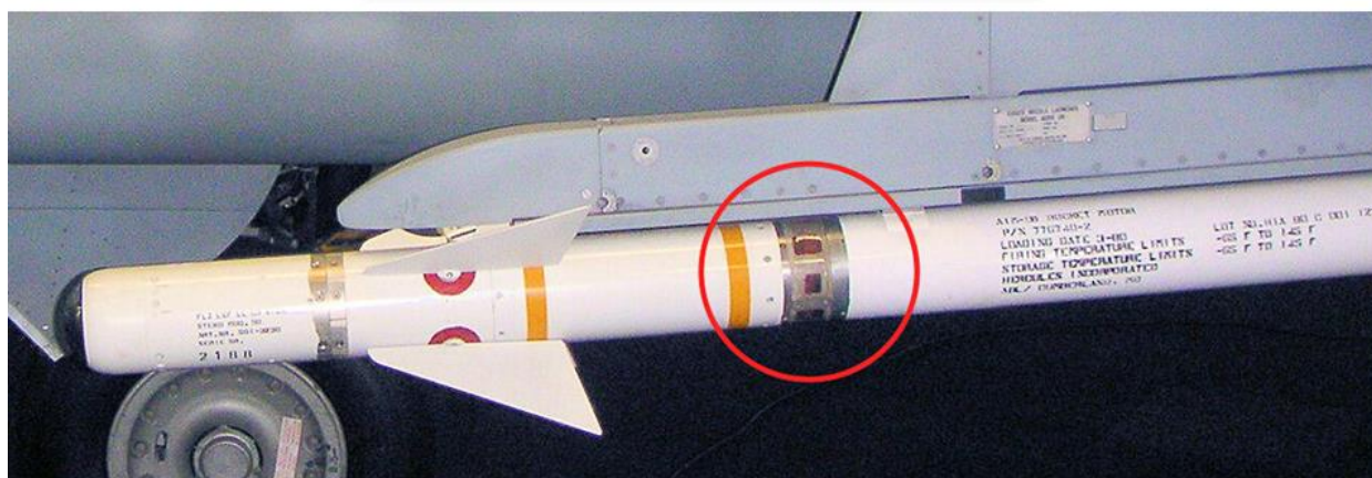
حسگر مجاورتی موشک هوا به هوای AIM-9B
